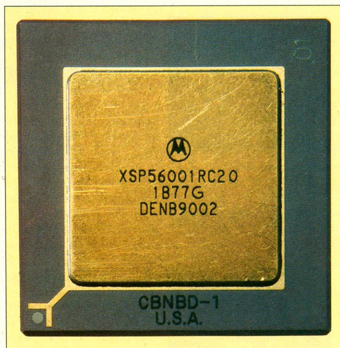
Der DSP 56001 im Pin-Grid-Array-Gehäuse
